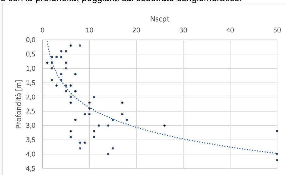
I risultati delle prove penetrometriche, riportati negli allegati istogrammi, sono stati interpretati per risalire, anche se indirettamente dato il tipo di prove eseguite, alle grandezze indice dei terreni investigati: densità relativa ( $d_r$  %), angolo d'attrito interno ( $\phi$ ), peso di volume ( $\gamma$ ) e modulo di Young (E).
