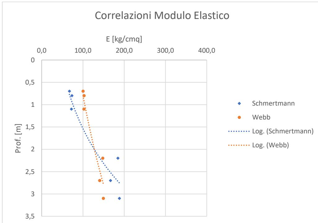
In base alle risultanze delle prove penetrometriche, sono state distinte, tre differenti “Litozone” abbastanza omogenee per caratteristiche tecniche, distinte in base ai valori medi di resistenza alla penetrazione.
